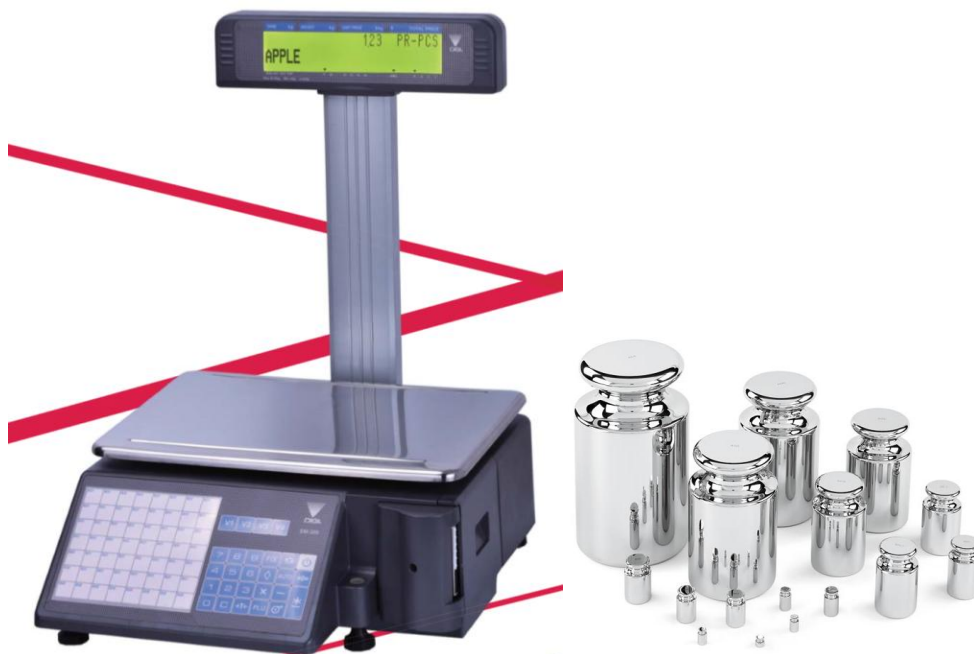
รูป 2.3 เมื่อเพิ่มน้ำหนัก 1g ลงบนแท่นชั่ง เครื่องชั่งแสดงค่า 998g เท่าเดิม หมายความว่า ความคลาดเคลื่อน > 2g
