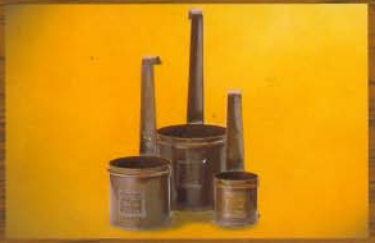
เครื่องตวงของเหลวชนิดทองเหลือง ใช้สำหรับตวงของเหลว น้ำปลา น้ำมีน้ากาด ของเหลวอื่น ๆ
