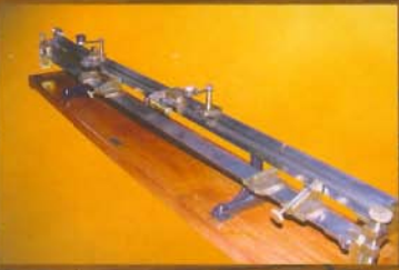
เครื่องวัดควมยาวแบบมาตรา พิกัดกำลัง 1 เมตร
