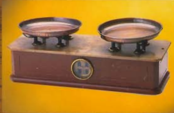
เครื่องชั่งแบบโรเบอรวัวล ใช้สำหรับชั่ง ยาสมุนไพร ส่วนประกอบของยา ในร้านขายยาไทยโบราณ
