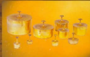
ตุ้มน้ำหนักแบบมาตรา ได้เป็น แบบมาตราสำหรับตองตอง ความเที่ยงของเครื่องชั่ง
