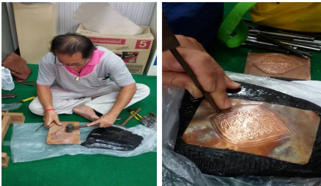
รูปที่ 3-21 ช่างเรียนรู้การดุนลายทองแดงสำหรับทำบังแทรก
