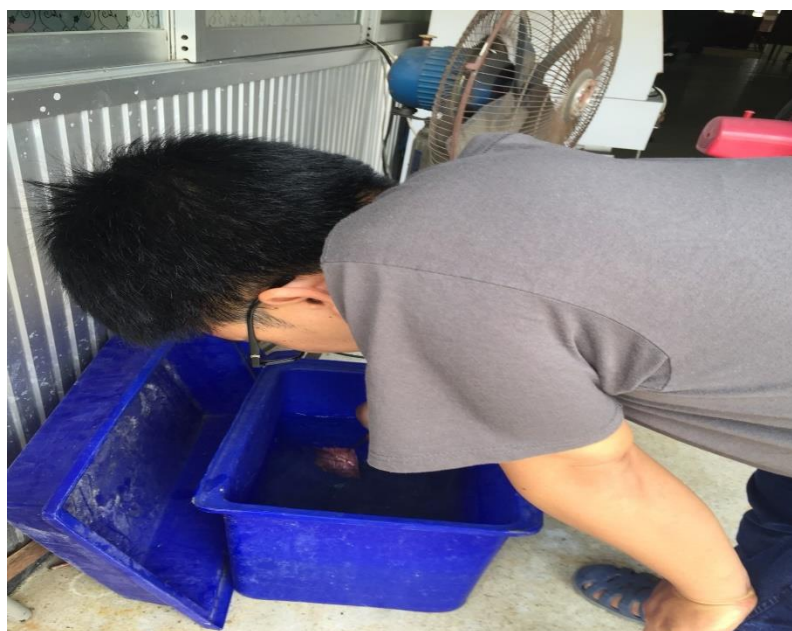
รูปที่ 3-22 ช่างเรียนรู้การกัดชิ้นงานด้วยน้ำกรด เพื่อทำความสะอาดผิวชิ้นงาน
